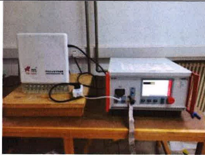
图1 电快速瞬变脉冲群抗扰度试验配置图
